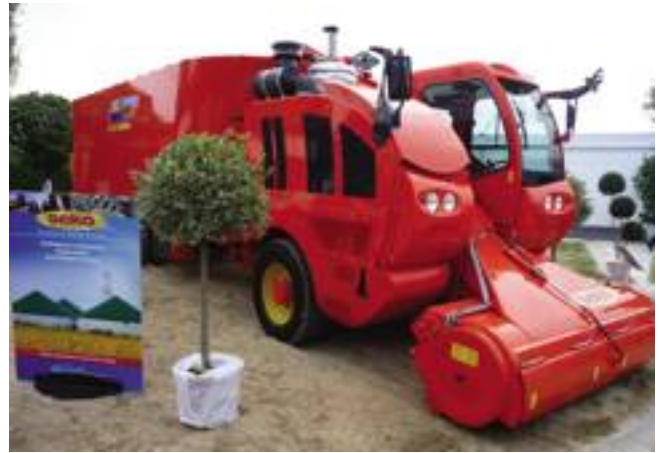
Ecco l'ultimo gioiello di casa SEKO: il più grande carro unifeed del mondo da 33 metri cubi e tre coclee verticali.
