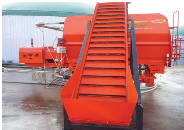
▲ Il Refiner è una macchina ideata e progettata da SEKO per la triturazione e la sfibratura della biomassa allo scopo di aumentare la superficie di attacco di molecole complesse e meno degradabili da parte dei batteri gasogeni
