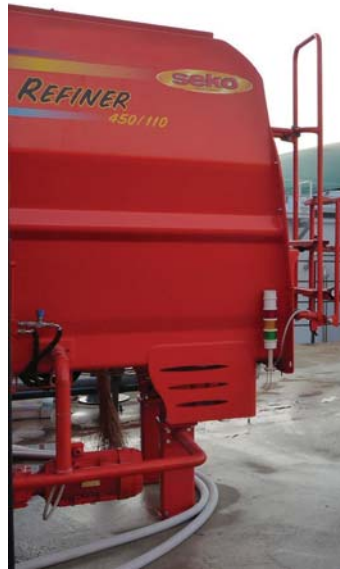
▲ A destra uno dei quattro digestori SEKO e a sinistra il Refiner per il pretrattamento della biomassa in entrata
