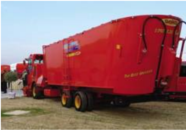
Ecco l'ultimo gioiello di casa SEKO: il più grande carro unifeed del mondo da 33 metri cubi e tre coclee verticali.
