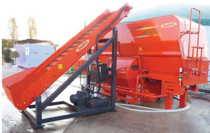
▲ Il Refiner è una macchina ideata e progettata da SEKO per la triturazione e la sfibratura della biomassa allo scopo di aumentare la superficie di attacco di molecole complesse e meno degradabili da parte dei batteri gasogeni
