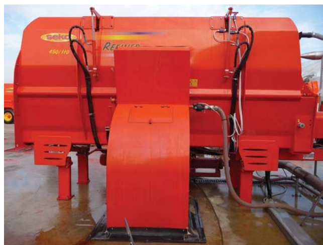
▲ Refiner è una macchina progettata da SEKO per la microritrazione della massa solida che permette di agevolare l'azione successiva dei batteri
